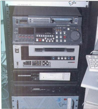
**Vtr nel rack.** Un rack che mostra, tra le altre apparecchiature, anche un videoregistratore Panasonic DVCPRO 50 Mbit/s.
